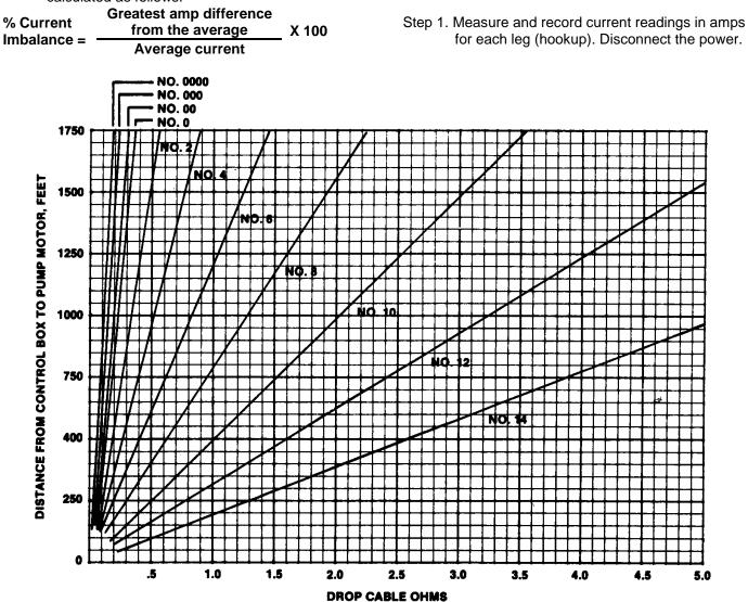
VALUES SHOWN ARE FOR COPPER CONDUCTORS AT 25°C (77°F.) VALUES ARE FOR TOTAL RESISTANCE OF DROP CABLE FROM THE CONTROL BOX TO THE MOTOR AND BACK. FOR ALUMINUM DROP CABLE DIVIDE THE CHART VALUE BY 0.61.
