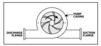
FIGURE 3. VANE POSITION FOR PROPER ROTATION
